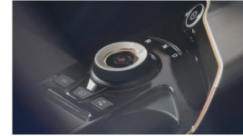
التحول عن طريق السلك (sbw) ناقل الحركة الدوار
