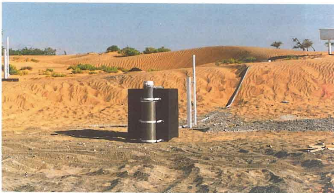
Hidroindicador en el cauce de Al Batha cerca de Al Kamil. El indicador registra el caudal de agua que pasa por el cauce. (Foto: PDO)
