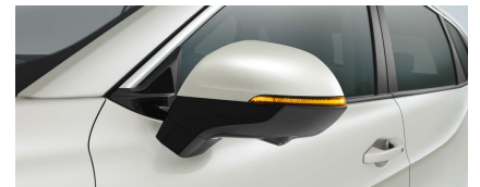
المرآة الخارجية للرؤية الخلفية قابلة للطي آلياً مع خاصية الذاكرة و الإرجاع المتزامنة
