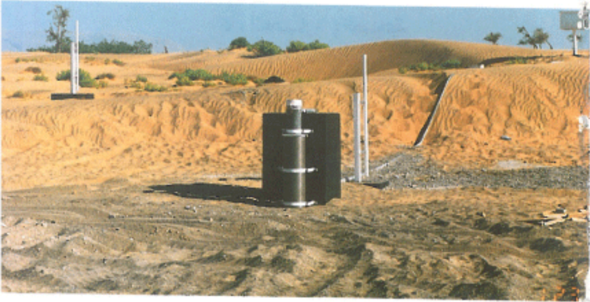
مقياس لمعرفة منسوب المياه في وادي بات بولاية الكامل بالمنطقة الشرقية
