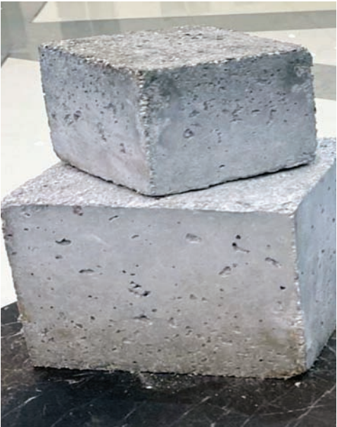
النموذج الأول للطوب المقاوم للتشققات والعازل للحرارة الذي ابتكرته إحدى الشركات الطلابية بالكلية المهنية بشناس
