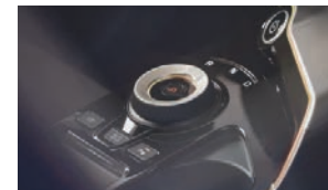
التحول عن طريق السلك (sbw) ناقل الحركة الدوار
